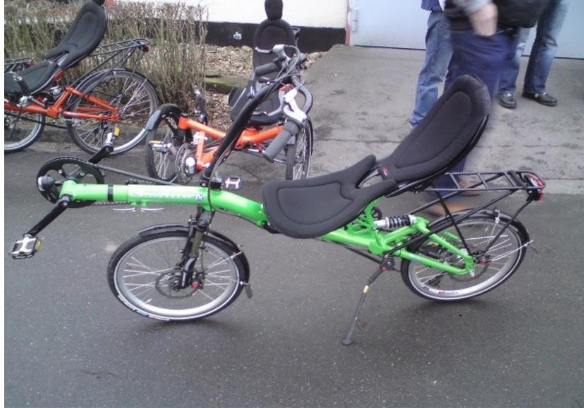
Großer Sitzkomfort, kleines faltmaß: Das ist das faltbare Tourenliegerad GrassHopper fx. Der voll gefederte Flitzer lässt sich in nur einer Minute auf 96x60x70 cm (mit Obenlenker) bzw. 96x50x70 cm (mit Untenlenker) falten. Zum Einsatz kommt ein solides faltgelenk mit integriertem Sicherungsbolzen in der Rahmenmitte.
